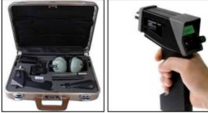
Şekil 6.9. Ultrasonik sızıntı dedektörü
