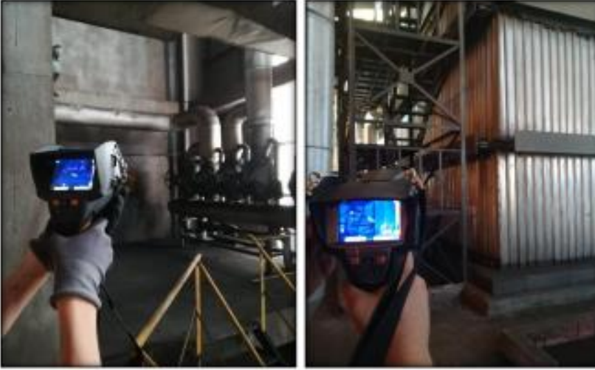
Şekil 9.2. Örnek izolasyon ölçümleri
