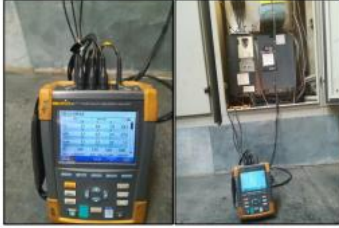
Şekil 5.4. Enerji analizörü ile fanların aktif güç ölçümleri
